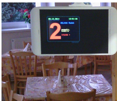
Terminál pro výdej stravy TM120SREG2 z pohledu obsluhy výdeje
